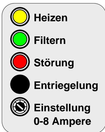
Die Drehstrom-Filterpumpe wird durch einen steckbaren, elektronischen Motorschutz vor Beschädigung durch Überlastung geschützt. Dazu muß der Motorschutz auf den Nennstrom der Filterpumpe (siehe Typenschild der Pumpe) eingestellt sein. Falls der Nennstrom der Filterpumpe nicht bekannt ist, kann der Motorschutz nach folgendem Verfahren eingestellt werden:
